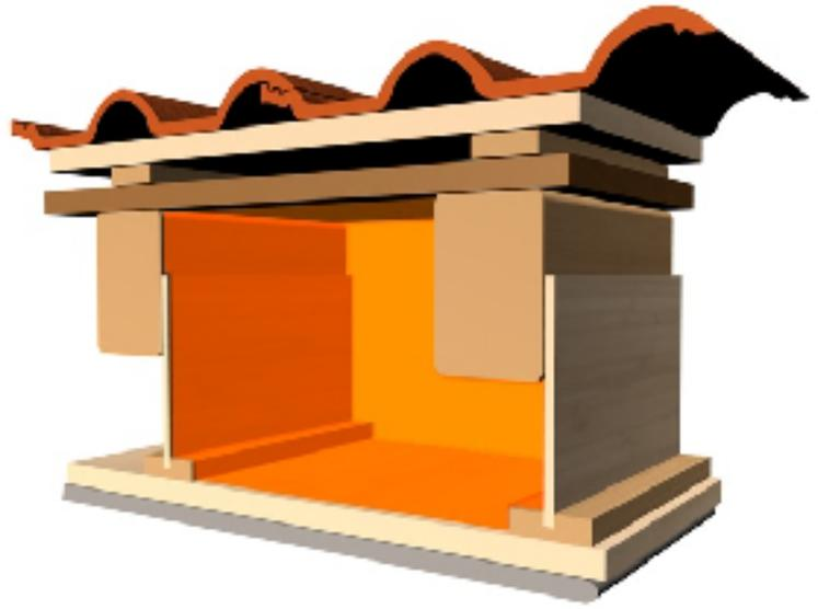
Pour un entre-axe des chevrons de 100 cm = résistance jusqu'à 100 kg/m<sup>2</sup>
